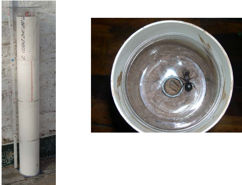
Abb. 2.1: Versuchsaufbau. Links : Ein mit Erde gefülltes Abflussrohr mit einer Höhe von 80cm. Rechts : Plastikbecher, der sich auf der Erdoberfläche befand. In der Mitte des Becherbodens befand sich eine Öffnung so, dass einerseits das Graben am Rand verhindert wurde, andererseits aber ein Zugang zur Erde vorhanden war.
