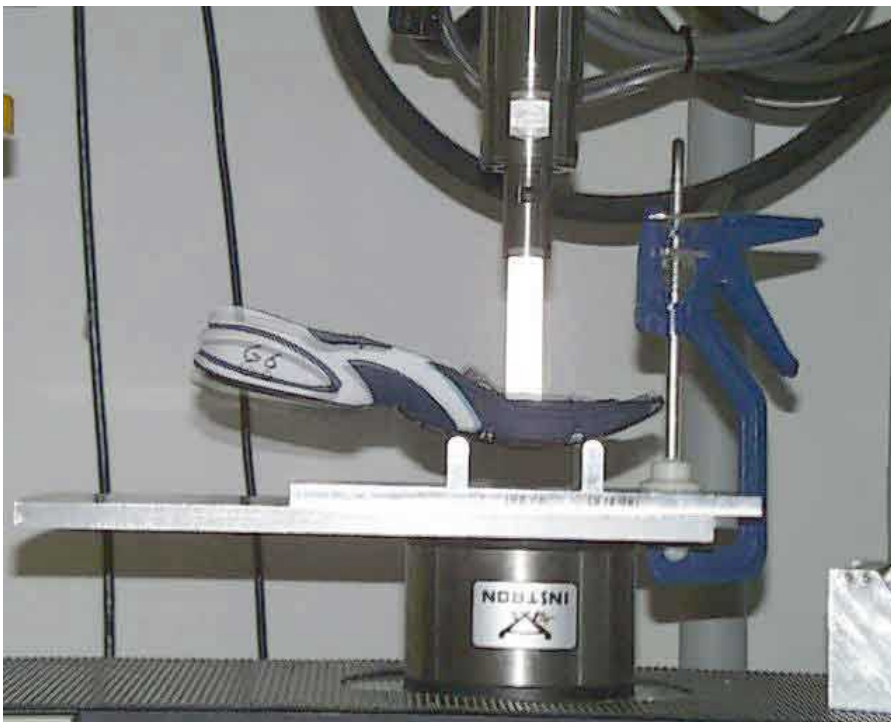
Abb.06 Materialorientierter Flexibilitätstest (3-Punkt-Biegung)
