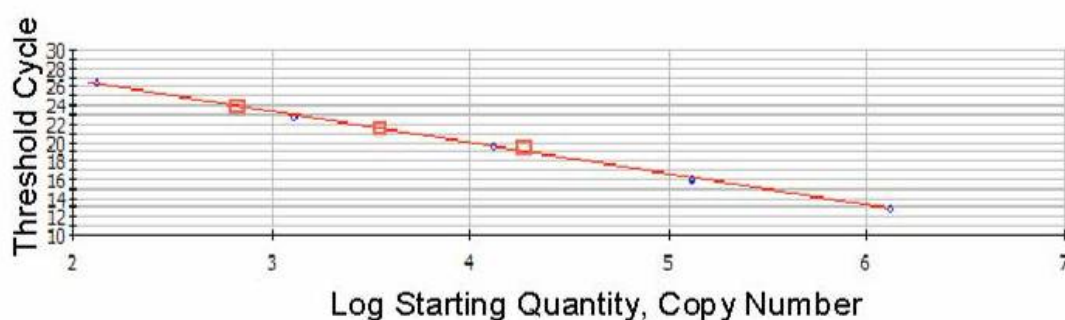
Abb. 14: Standardkurve zur Bestimmung der absoluten DNA-Konzentration.
