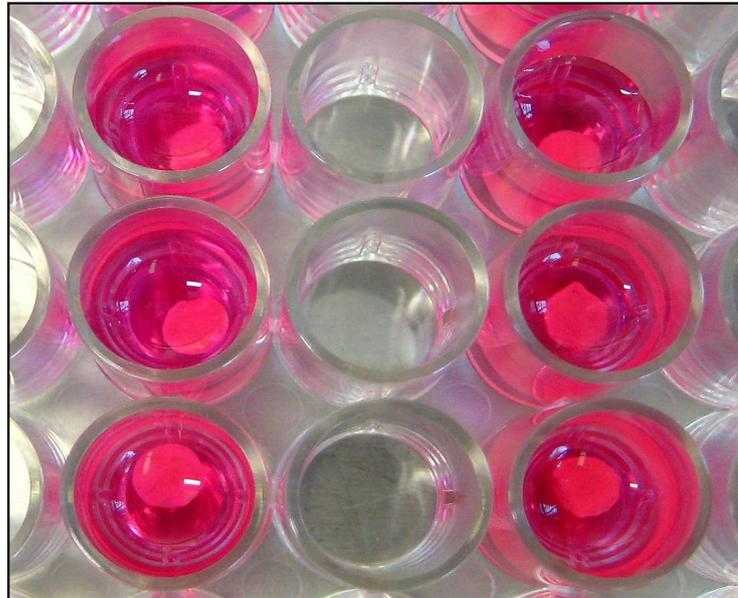
Abb. 7: Vertiefungen einer 48-Well-Platte, gefüllt mit 700  $\mu$ l chondrogenem Differenzierungsmedium. Am Boden der Vertiefungen befinden sich die mit mesenchymalen Fettstammzellen besiedelten Polyurethan-Fibrin-Konstrukte.
