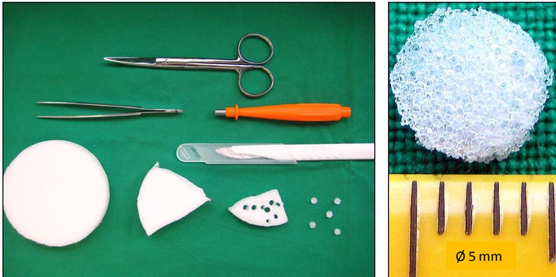
Abb. 6: Herstellung der Polyurethan-Konstrukte,  $\varnothing$  5 mm, Höhe 2 mm
