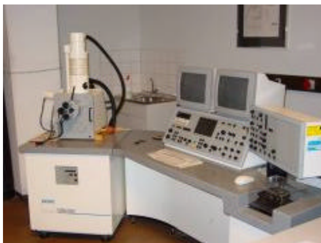
Abb. 5-3: Rasterelektronenmikroskop Zeiss DSM962
