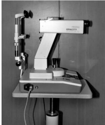
Abb. 2.1.: Das Lens Opacity Meter 702® der Firma Interzeag, Schweiz, messbereit.
