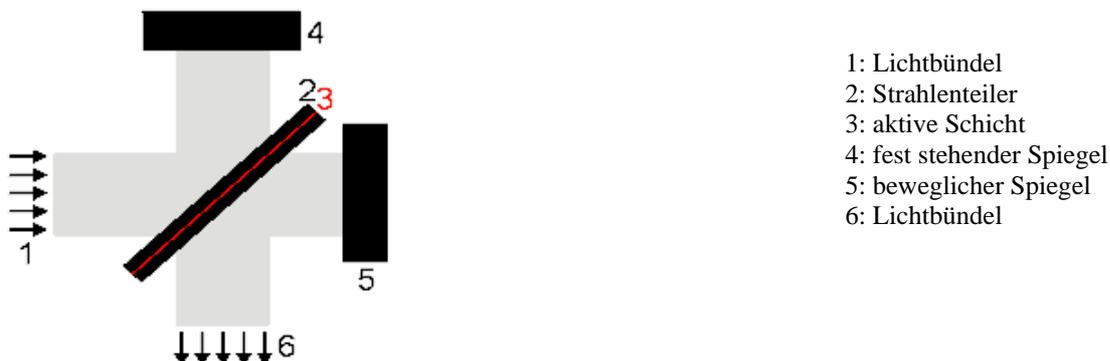
Abbildung 2.10: Aufbau eines Interferometers
