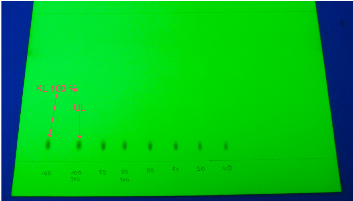
Abbildung 5.7.1-3: Dünnschichtchromatogramm der Bestimmung des Fertigarzneimittels „Paludrine“ unter UV-Licht bei \lambda=254 nm; UL=Untersuchungslösung, KL=Kalibrierlösung.
