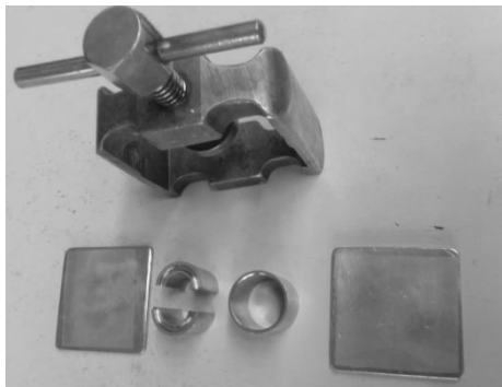
Abbildung 7: Negativform der zylindrischen Probekörper (eigenes Bildmaterial)
