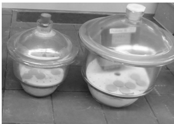
Abbildung 6: Alginatprobekörper in Exsikkatoren (eigenes Bildmaterial)
