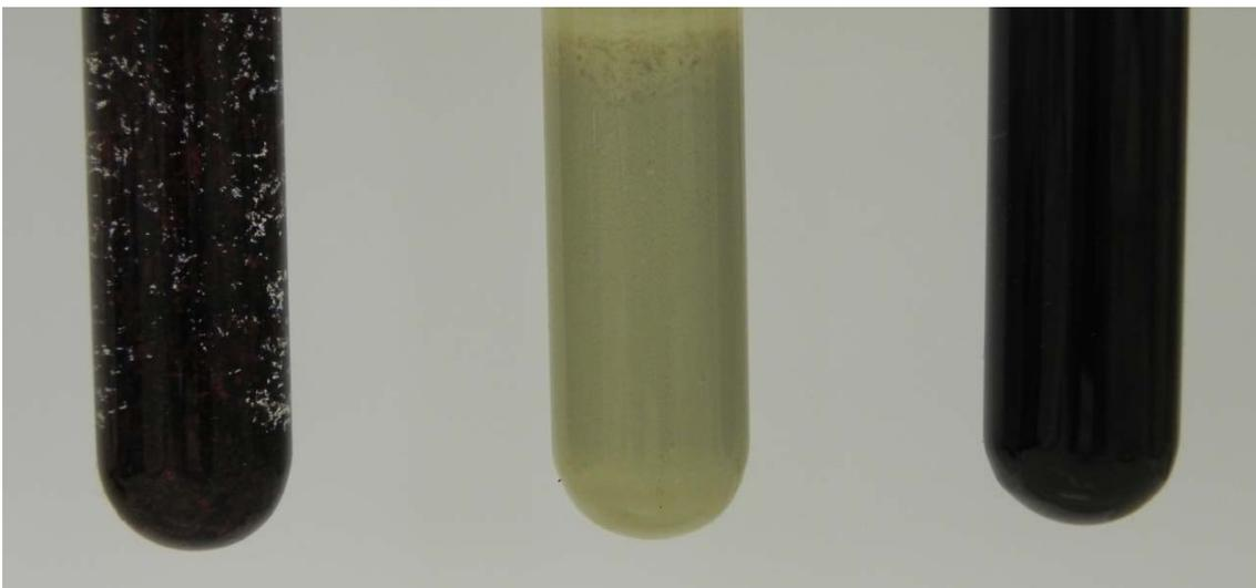
Abbildung 53: Dispersionen von Fe-MEPE, Nanofil 116 und Fe-MEPE-MMT in Silikonöl (von rechts nach links). Im Vergleich mit den Nanokompositen ist die schlechtere Homogenität der reinen MEPE-Silikonöl-Proben erkennbar.
