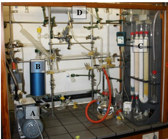
Abbildung 3.1: Vollglasschutzgas-Apparatur mit Vakuumpumpe (A), Kühlfalle (B), sowie Trockenturm-Aufbau (C) und Titanschwamm in Röhrenofen (D).
