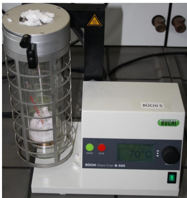
Abbildung 3.3: Büchi-Glasofen mit digitaler Steuerung und aufrechter Heizkammer.
