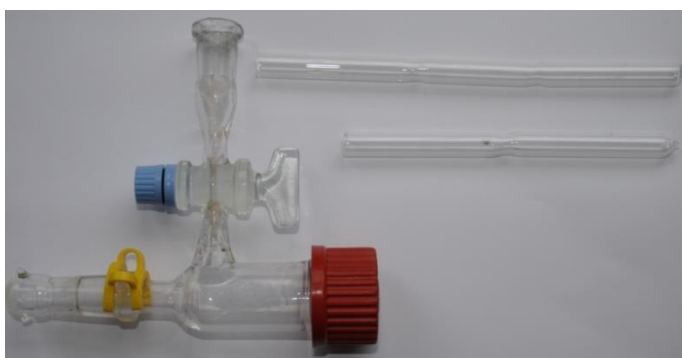
Abbildung 3.2: Quickfit mit Hahn und Schliff (links) und Zweikammer- (oben, rechts) sowie Einkammer-Ampulle (mitte, rechts).
