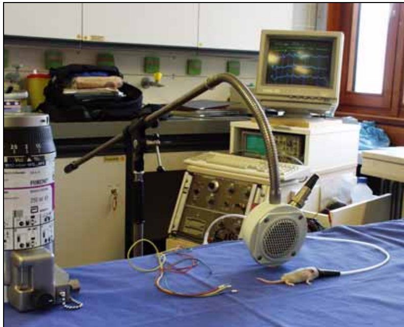
Abbildung 2-1: Versuchsaufbau mit Narkoseeinheit und BERA Messvorrichtung.
