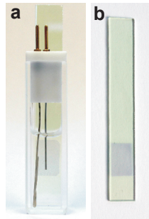
Abbildung 3.2: a) Elektrochemische Zelle mit ITO-Arbeits- und Silber-Gegenelektrode (links) und Platin-Referenz (Mitte). b) ITO beschichteter Objektträger mit aufgebrachtem (6,5)-SWNT-Film.
