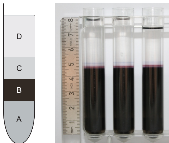
Abbildung 4.1: Schematische Darstellung des Dichtegradienten zur Isolierung von (6,5)-SWNTs und Zentrifugenröhrchen nach erfolgreicher DGU. Die (6,5)-SWNTs befinden sich dabei im Bereich der violetten Bande, deren Farbe vom entsprechenden S_2 -Übergang herrührt.
