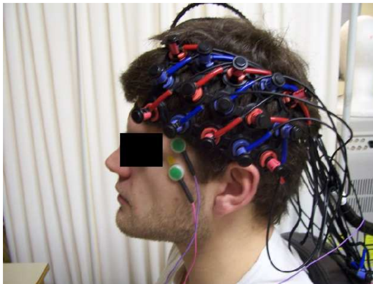
Abb. 2.3: Position von Probeset (Nah-infrarot Optoden; Rot: Emitter, Blau: Detektoren) sowie EMG-Elektroden (grüne Elektroden), angebracht auf Bauch und Ansatz des Musculus temporalis an der Schläfenregion.
