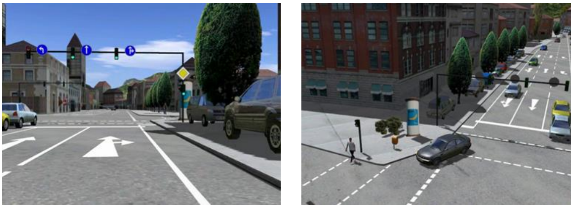
Abbildung 2: Anwendungsbeispiel für Unterstützungsmöglichkeiten durch kooperative Umfelderkennung. In der Anfahrt an eine Kreuzung ist ein Fußgänger durch Objekte am Straßenrand sowohl aus Sicht des Fahrers (welcher rechts abbiegen möchte, siehe linker Teil der Abbildung) als auch für auf fahrzeuglokaler Sensorik basierende Assistenzsysteme verdeckt. Durch kooperative Umfelderkennung ist eine Fahrerunterstützung auch in solchen Konfliktsituationen möglich.
