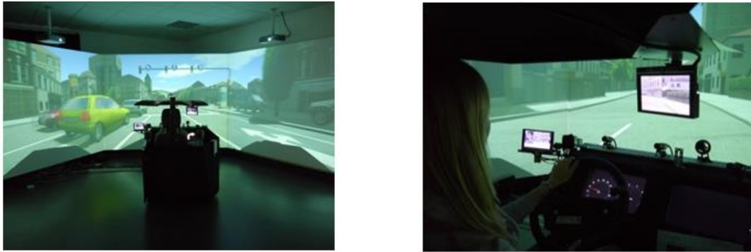
Abbildung 8: Statischer Fahrsimulator der WIVW GmbH (links: Außenansicht, rechts: Innenansicht).
