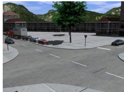
Abbildung 14: Situation „Kreuzender PKW“: Umsetzung der Verdeckung durch parkende Fahrzeuge; Sicht des wartepflichtigen Ego-Fahrers (links) und Vogelperspektive von der gegenüberliegenden Seite (rechts).
