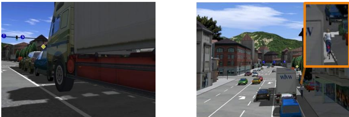
Abbildung 12: Situation „Rechtsabbiegender PKW“ – querender Radfahrer“: Umsetzung der Verdeckungssituation durch parkende Fahrzeuge am Straßenrand aus Fahrersicht (links) und Vogelperspektive (rechts). Die Vogelperspektive zeigt den Ego-Fahrer (dunkelgraues Fahrzeug) und den sichtverdeckten Radfahrer.
