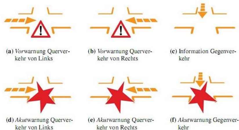
Abbildung 5: Beispiele für richtungsspezifische Informations- (oben) und Warnsymbole (unten, nach Fuerstenberg et al., 2007). Das Konzept wurde innerhalb des Forschungsprojekts INTERSAFE vorgestellt. Evaluationsergebnisse in Bezug auf die Fahrerreaktion werden nicht berichtet.
