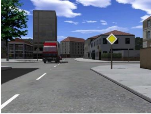
Abbildung 13: Situation „Abbiegender PKW“: In dieser Situation nimmt dem Ego-Fahrer ein abbiegender PKW die Vorfahrt. Umsetzung der Verdeckungssituation durch einen entgegenkommenden LKW aus Sicht des vorfahrtsberechtigten Ego-Fahrers (links) und Vogelperspektive (rechts).
