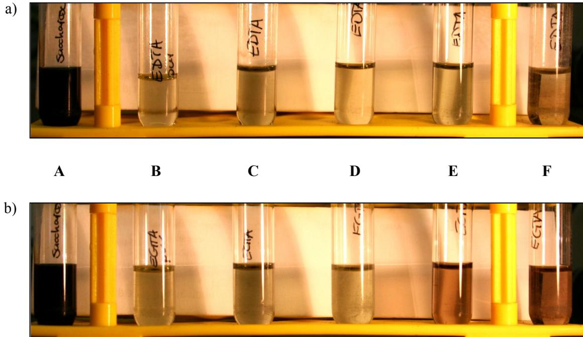
Abbildung 73. Anfärbung von verschiedenen Lösungen (A: Saccharose-Lösung 1 mg mL<sup>-1</sup>, B: Sammellösung pur, C–F: Sammellösungen mit Phloemexsudaten) mit dem Anthronreagenz nach Phloemsammlung aus *A. thaliana*-Blättern mit a) 5 mM EDTA-Lösung; und b) 5 mM EGTA-Lösung.
