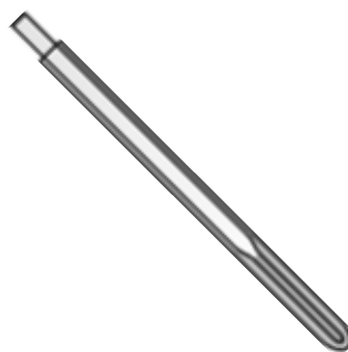
Abbildung 4.4-1: NMR-Röhrchen mit koaxialem Innenröhrchen
