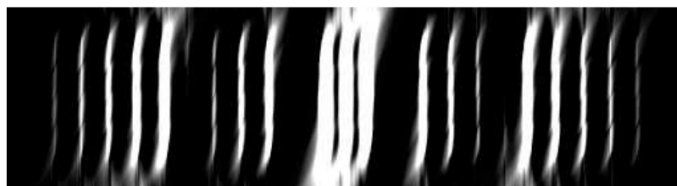
Abbildung 10.8: Die Rekonstruktion eines asymmetrisch aufgenommenen Datensatzes des Testobjekts zeigt eine Verzerrung der Hütchenartefakte. Dieser Datensatz wurde mit M = 100 und nur 27 Projektionen berechnet, wobei eine starke Asymmetrie von 2 zu 24 Projektionen je Seite angenommen wurde. Es ist zu erkennen, dass vor allem die Tiefenauflösung bei den größeren Strukturen reduziert ist. Mit freundlicher Genehmigung von A.C. Rimbach.
