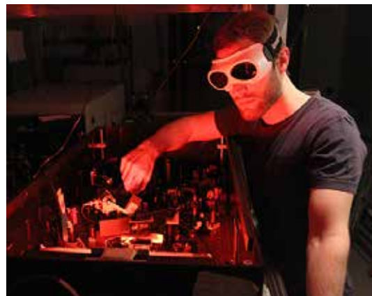
Christian Kramer justiert den Pulsformer, der ultrakurze Lichtimpulse für die Messungen mit dem Elektronenmikroskop moduliert.
