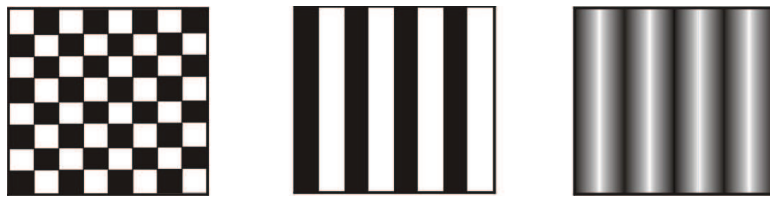
Abbildung 1.4: Schachbrettmuster, Rechteckgitter, Sinusgitter . Die drei in der Praxis am häufigsten verwendeten Reizmuster
