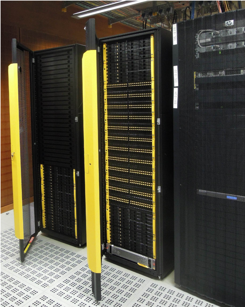
Abbildung 14: Speichersystem HP 3PAR 7400
