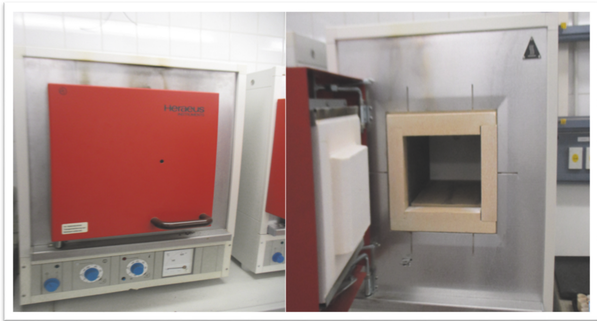
Photo n°16 : Dispositif de détermination de la matière organique et des carbonates (le four à gauche) et chambre à combustion des échantillons (à droite). ©Matériels de l'Université Libre de Berlin.
