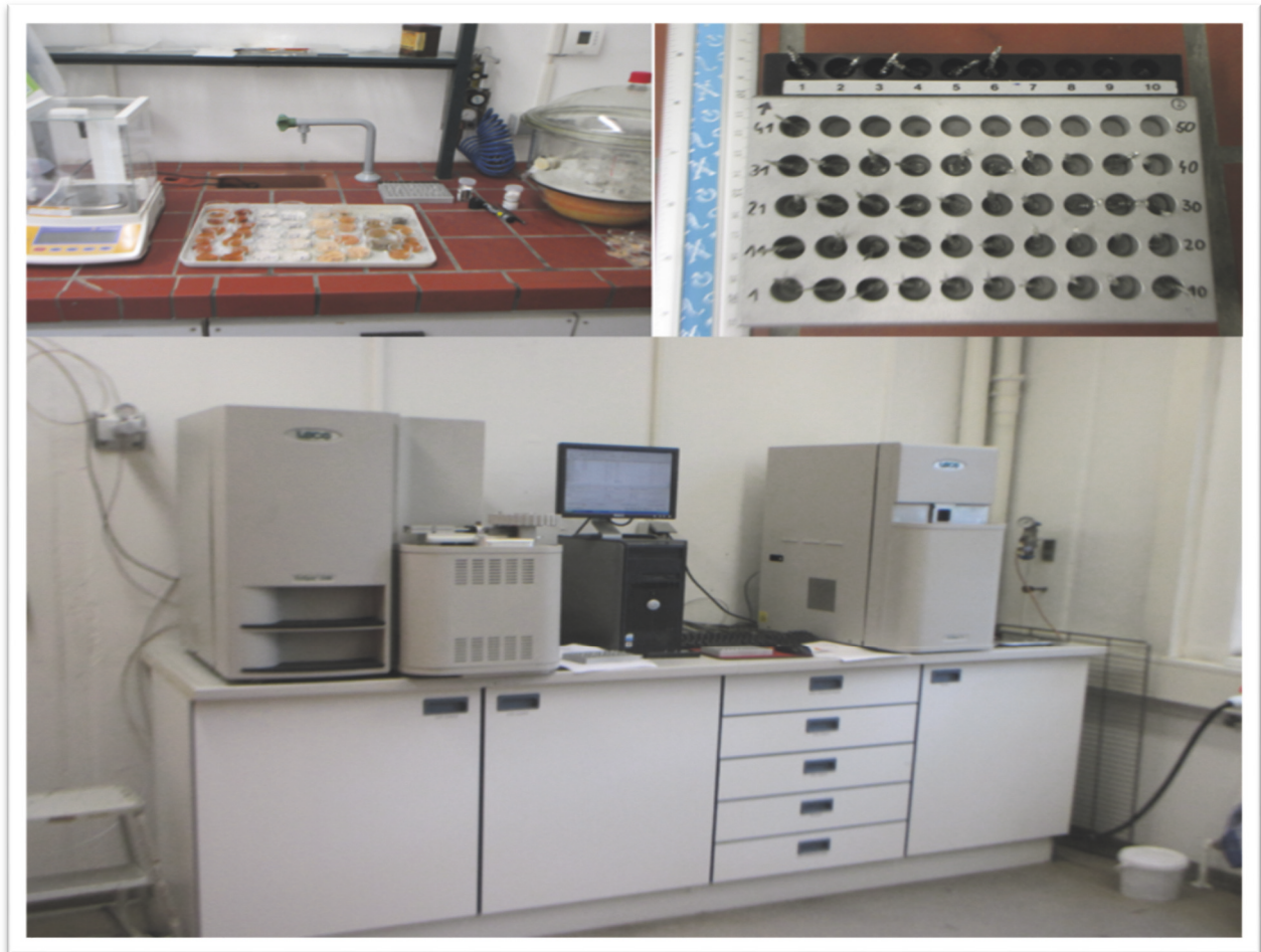
Photo n°18 : Préparation des échantillons (en haut) et dispositif d'analyse CNS automatisé (en bas). ©Matériels de l'Université Libre de Berlin.
