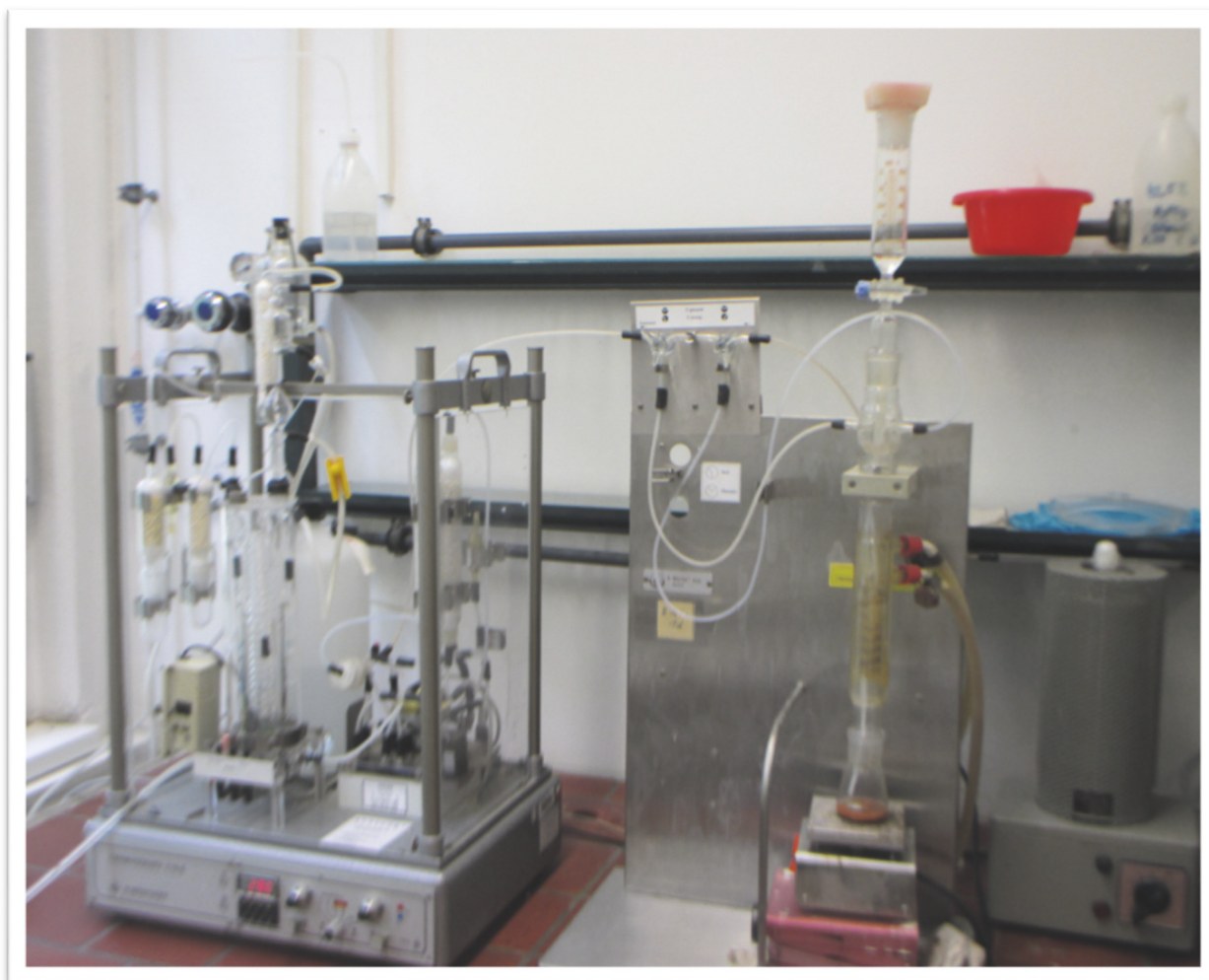
Photo n°17 : Dispositif de H.Wölsthoff pour la détermination du carbone inorganique (Carmhograph C-16). ©Matériels de l'Université Libre de Berlin.
