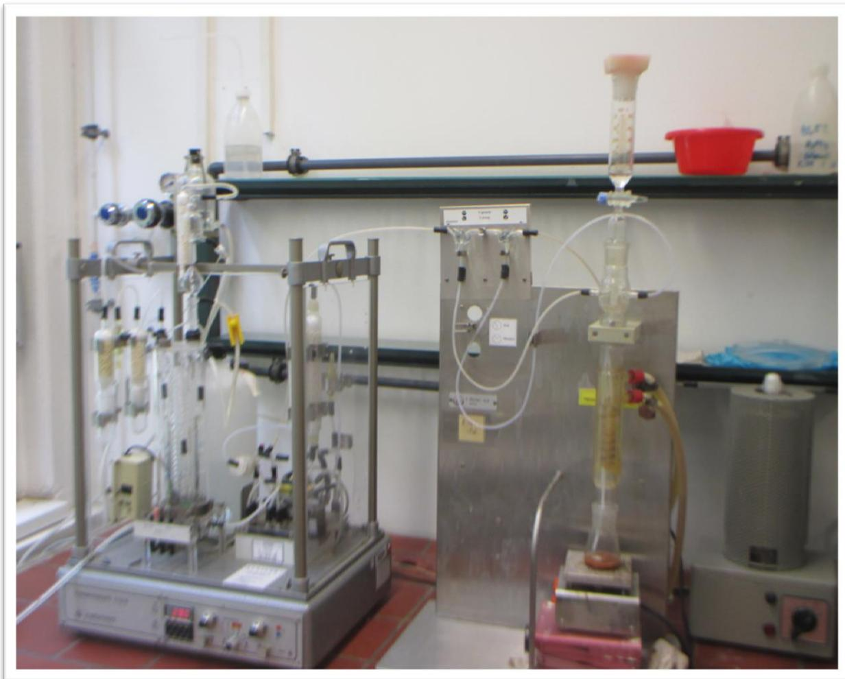
**Photo n°17 :** Dispositif de H.Wölsthoff pour la détermination du carbone inorganique (Carmograph C-16).
