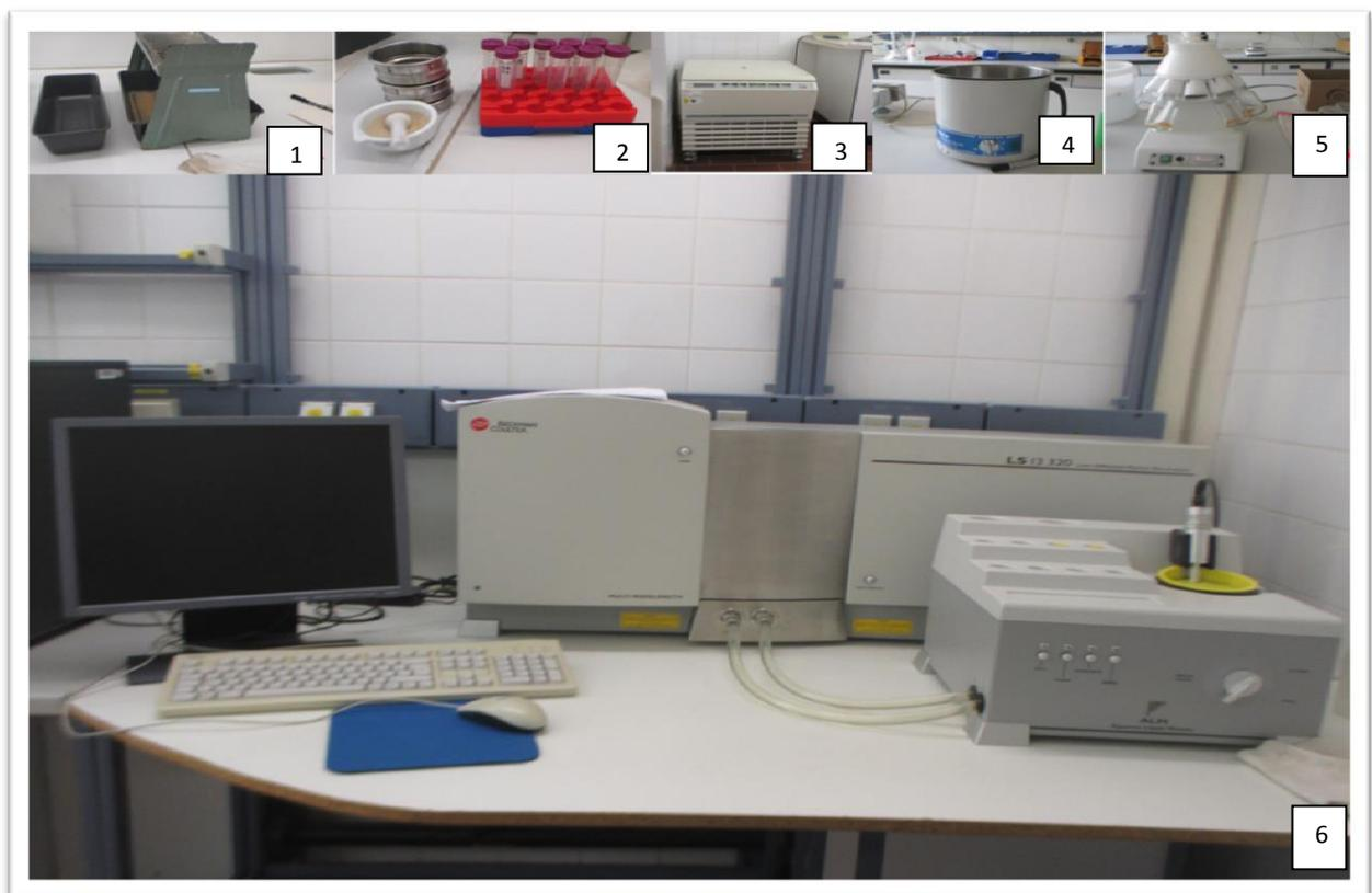
**Photo n°11:** Différentes étapes de l'analyse granulométrique au laser des échantillons : quartage de l'échantillon brut (1), désagrégation et tamisage mécanique (2), centrifugation (3), désagrégation aux ultrasons (4), 2<sup>e</sup> quartage (5) et dispositif d'analyse au laser (6). ©Matériels de l'Université Libre de Berlin.
