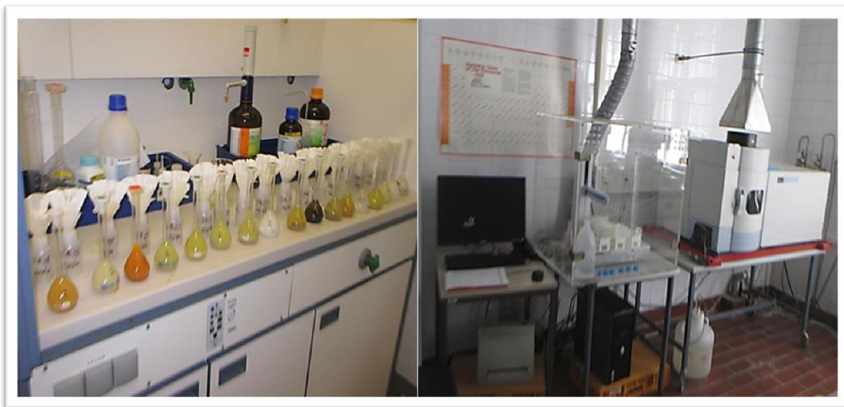
**Photo n°13** : Dispositif d'analyse ICP/OES : dissolution des échantillons à l'eau régale (à gauche) et dispositif automatisé d'analyse par analyseur ICP-OES (à droite). ©Matériels de l'Université Libre de Berlin.
