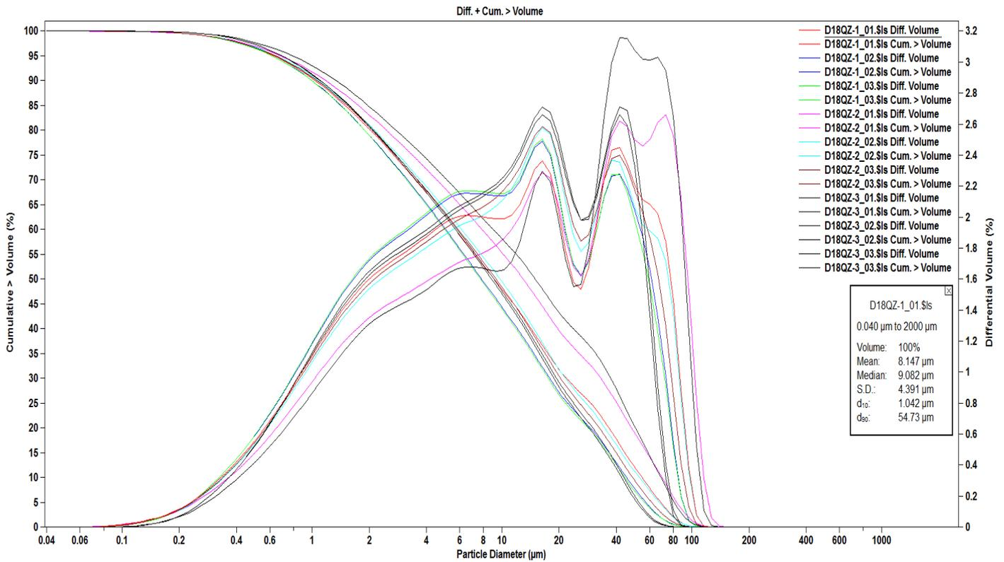
**Graphique n°2 :** Courbes de fréquences simples et cumulées de quelques échantillons homogénéisés
