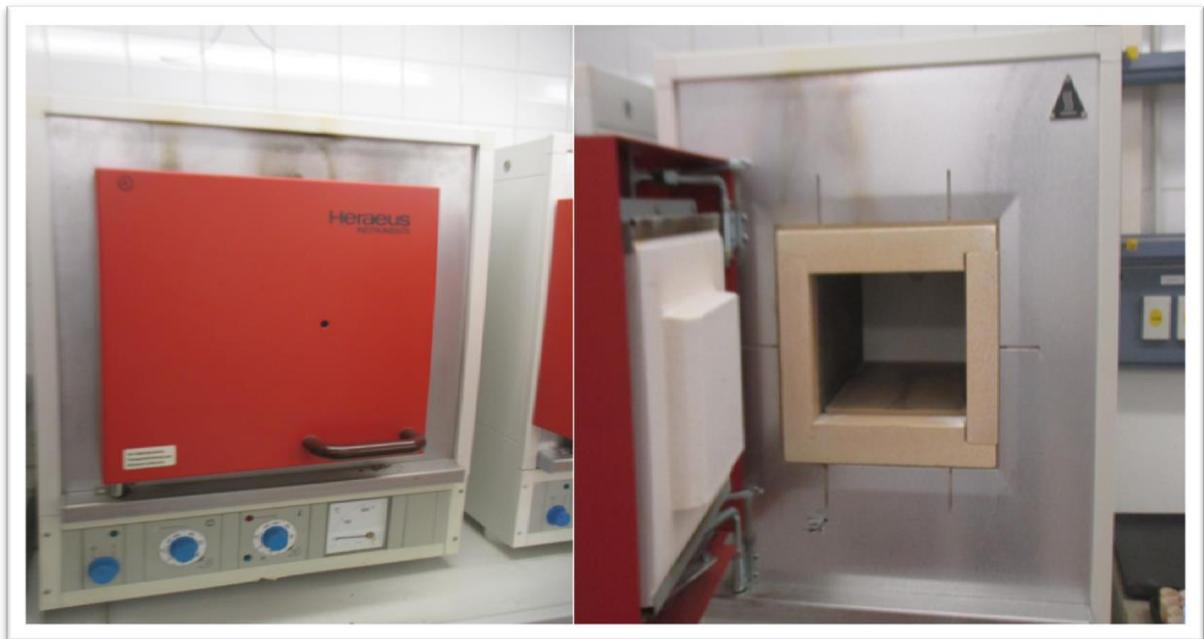
**Photo n°16 :** Dispositif de détermination de la matière organique et des carbonates (le four à gauche) et chambre à combustion des échantillons (à droite). ©Matériels de l'Université Libre de Berlin.
