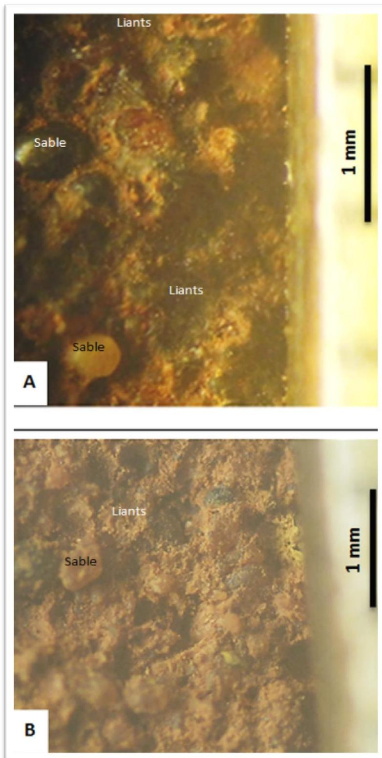
**Photo n°26** : Caractéristiques macroscopiques des matériaux sableux sous-jacents aux croûtes biogéniques dégradées et concrétionnées (ADM 05°03'-05°40' E et 14°09'-14°39' N). En haut vue de surface et en bas vue de profil.
