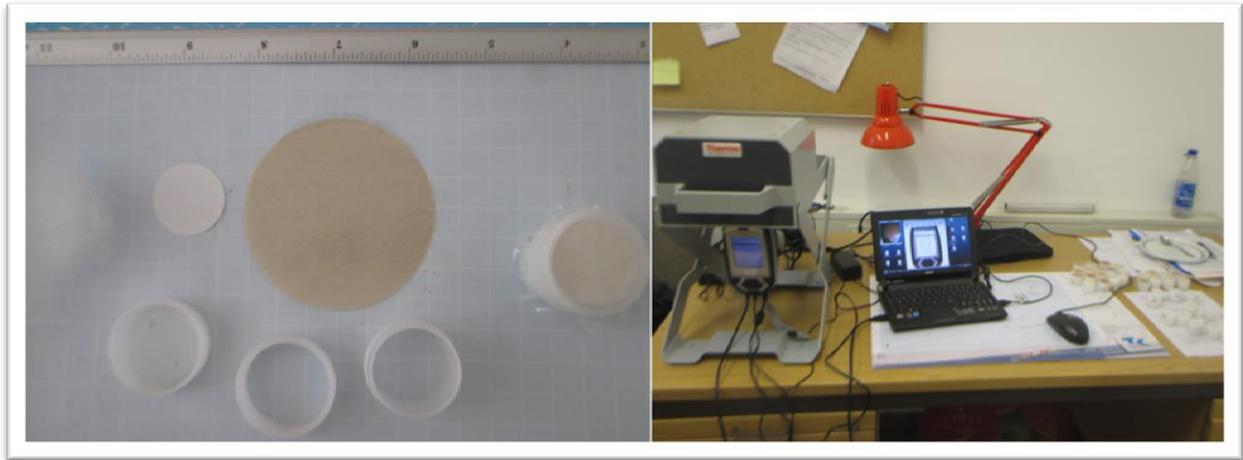
**Photo n° 14:** Dispositifs et outils d'analyse RFA. A gauche : préparation échantillons (contenant d'échantillon /FluXana T-F 240-255). A droite, dispositif d'analyse échantillons (NITON XL3t GOLDD). ©Matériels de l'Université Libre de Berlin.
