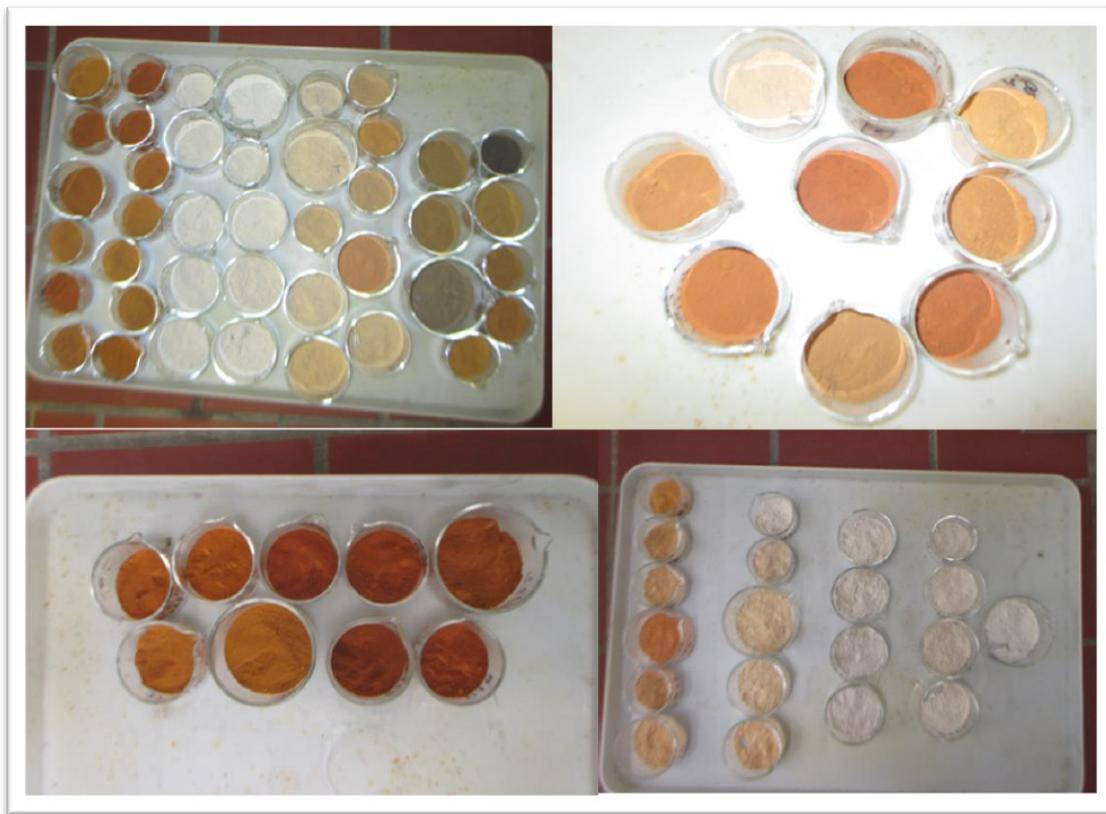
**Photos n°12 :** Pulvérisation-homogénéisation des échantillons analysés en laboratoire (ce sont des artefacts des échantillons prélevés dans les couches superficielles des dunes entre 0 et 20 cm). Ceux-ci sont réduits en poudre pour le besoin des analyses géochimiques et minéralogiques.
