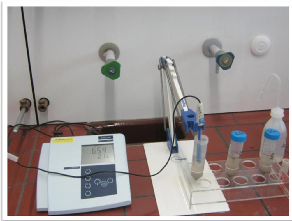
**Photo n°19 :** Dispositif de mesure du potentiel-Hydrogène des échantillons (pH-mètre WTW InoLab 7110). ©Matériels de l'Université de Würzburg.
