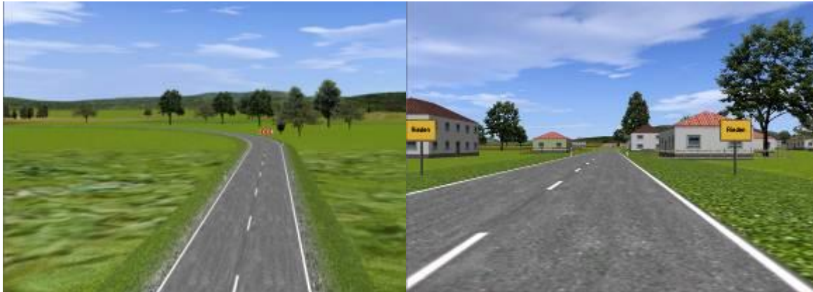
Abbildung 14: Scharfe Linkskurve mit einem Radius von 70 m (links) und Ortseinfahrt (rechts).
