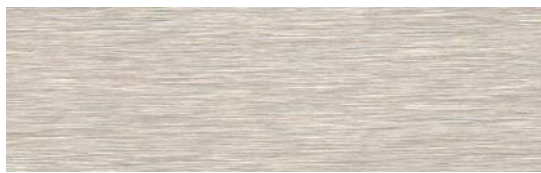
Abbildung 2.4: Längsschliff auf unpoliertem Stahlträger (Foto, ohne zusätzliche Vergrößerung)
