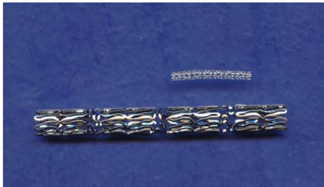
Abbildung 1: Stent in Originalgröße (oben) und Modellstent 10:1 (unten)
