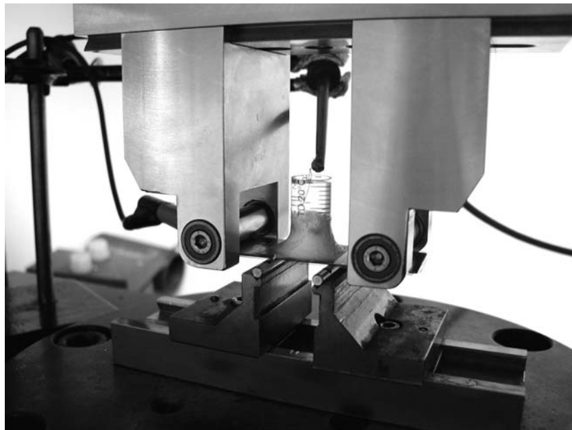
Abbildung 4.14: Versuchsanordnung zur 4-Punkt Biegeprüfung mit gleichzeitiger Messung des Korrosionsstroms.
