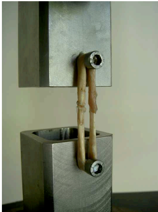
Abbildung 17: Zur Versuchsdurchführung an der Testmaschine angebrachter Sehnenring (Foto aus eigener Quelle)
