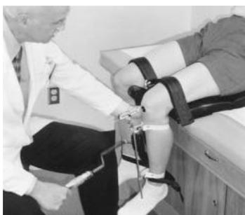
**Abb. 6.** KLT Arthrometer, Ausübung der nach posterior gerichteten Kraft mittels Kraftapplikator. (Aus [24])
