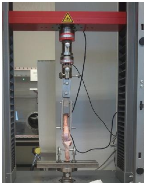
Abb. 12: Vorrichtung für die biomechanischen Messungen (sog. „Zwick“).
