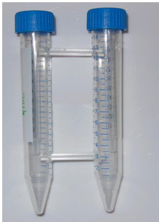
Abb. 10: Vorrichtung zur Herstellung von Kollagenfaserkonstrukten (sog. "Reiter").
