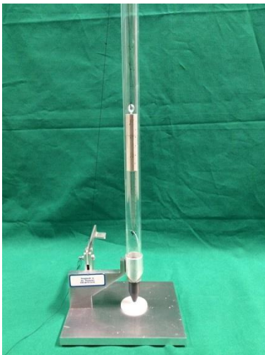
Abbildung 3-2. Apparatur zur Induktion eines diffusen Schädel-Hirn-Traumas. Das an einem Faden fixierte Gewicht wird aus definierter Höhe auf den Schädel der Maus fallen gelassen.
