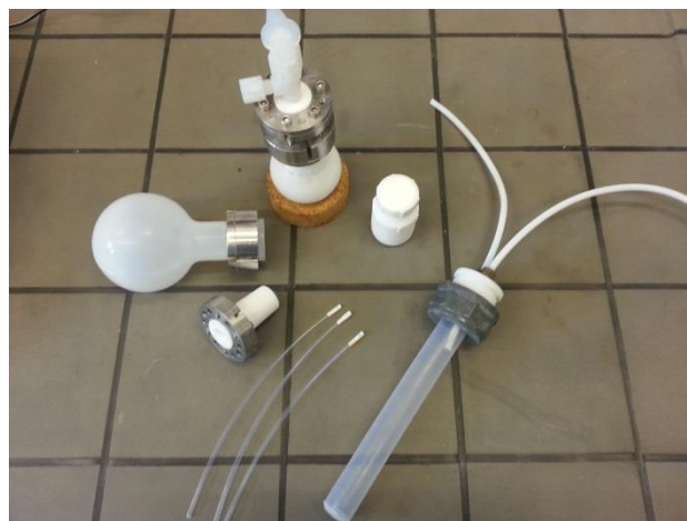
Bild 6.1: Verwendetes Labormaterial aus PFA, PTFE und Edelstahl für Arbeiten in/mit HF-Lösungen.
