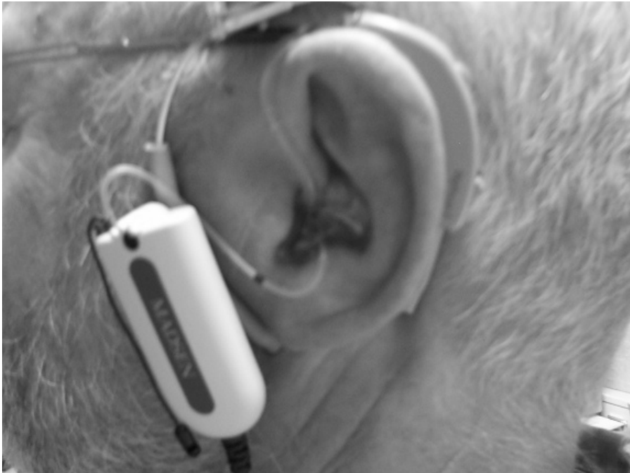
Bild 17: Ohr mit eingesetzter modifizierter Otoplastik und aufgesteckter Messsonde (schwarzer Stopp am Sondenschlauch ist hier sichtbar)
