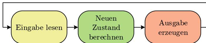
Abbildung 2.1: Ein einfacher *Simulation Loop* mit dem Lesen von Eingaben, Berechnung eines neuen Zustandes und der Ausgabe der Ergebnisse. Die farbliche Kennung mit Gelb für Eingabe, Grün für Zustandsberechnung und Rot für Ausgaben wird in der weiteren Arbeit beibehalten.
