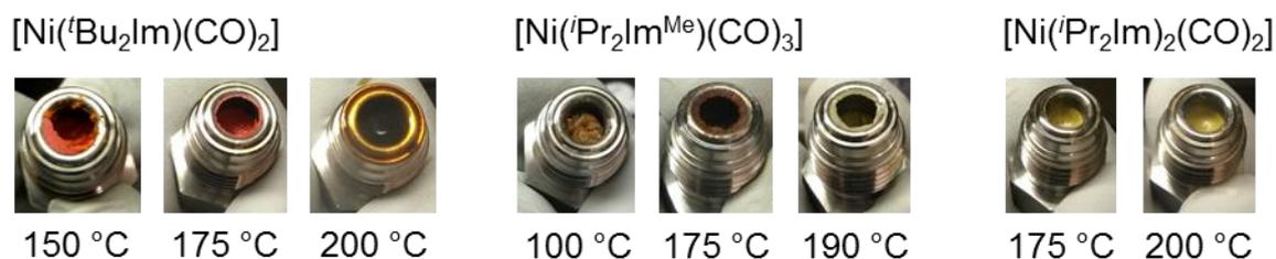
Abb. 3.90 Stabilitätstests der Verbindungen  $[\text{Ni}(\text{tBu}_2\text{Im})(\text{CO})_2]$  **4**,  $[\text{Ni}(\text{iPr}_2\text{Im}^{\text{Me}})(\text{CO})_3]$  **8** und  $[\text{Ni}(\text{iPr}_2\text{Im})_2(\text{CO})_2]$  **2** bei verschiedenen Temperaturen.
