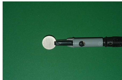
Abb. 3.5 Krokodilklemme als Gegenelektrode
