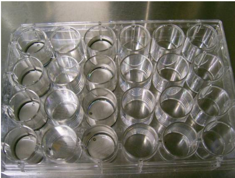
Abb. 8.1.6 24 Well Schale mit Titanplättchen und PBS Lösung
