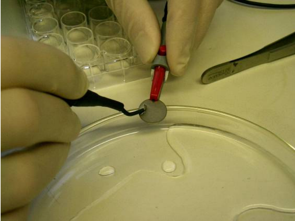
Abb. 8.1.7 Probenkörper während der Bekratzung
