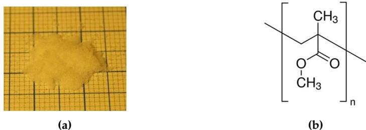
**Abbildung 3.2:** (a) Poly-methylmethacrylat ist ein feines weißes Pulver, das in dieser Arbeit in Chlorbenzol gelöst wurde. (b) Darstellung der molekularen Struktur von PMMA.
