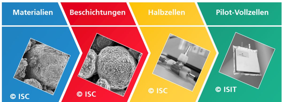
Abb. 3.1: Entwicklungsprozess vom anfänglichen Elektrodenmaterial bis hin zur fertigen verbesserten Batteriezelle (Bilder: © Fraunhofer ISC/ISIT).
