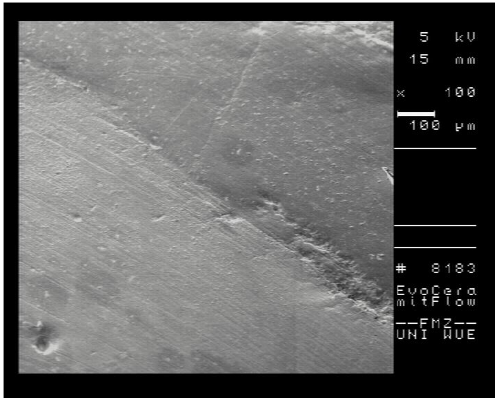
Abb. 11 Randqualität „kontinuierlicher Rand“, 100fache Vergrößerung, Übergangsbereich zervikal-axial, links unten Füllung, rechts oben Zahnschmelz (eigene Abbildung)
