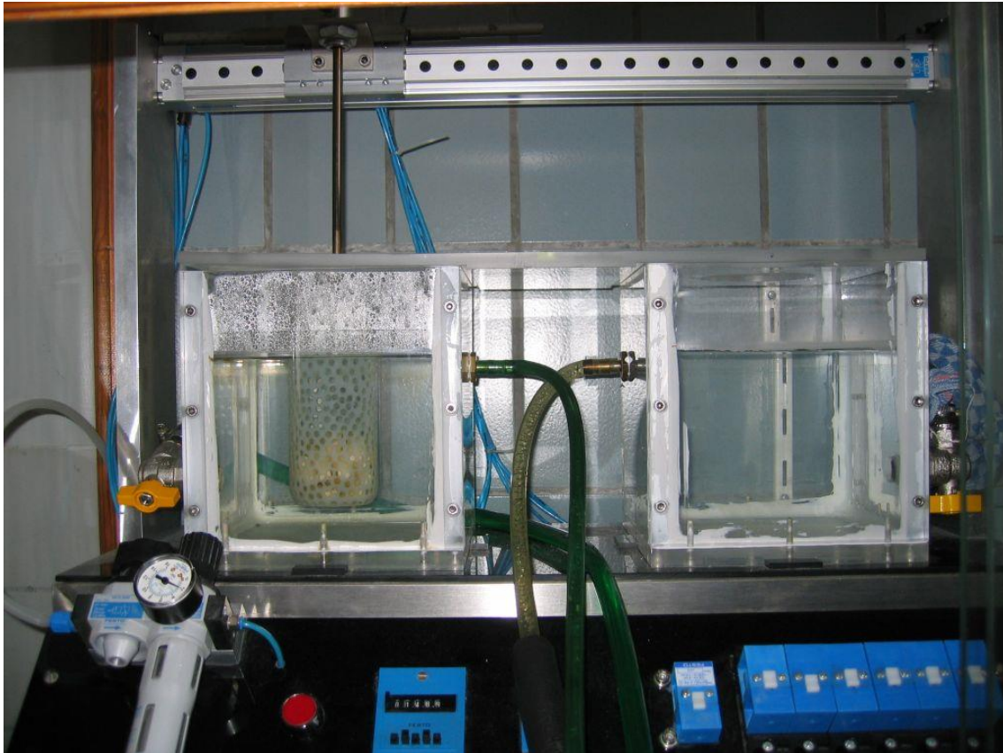
Abb. 10 Thermocycling: links Kältebad mit Temperatur von 5°C, rechts Wärmebad mit Temperatur von 55°C (eigene Abbildung)
