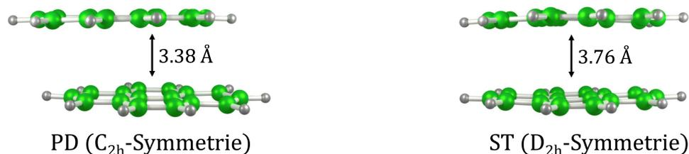
**Abbildung 6.2:** Grundzustandsgeometrien der isomeren Pyrendimere (BH-LYP/def2-SVP). Links: energetisch günstigste PD Geometrie mit  $C_{2h}$ -Symmetrie, Rechts: ST Geometrie mit  $D_{2h}$ -Symmetrie.
