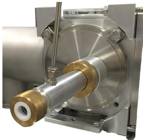
**Abbildung 3.11:** Gaszelle an der Hauptkammer zur Erzeugung von Strahlung im VUV-Bereich.
