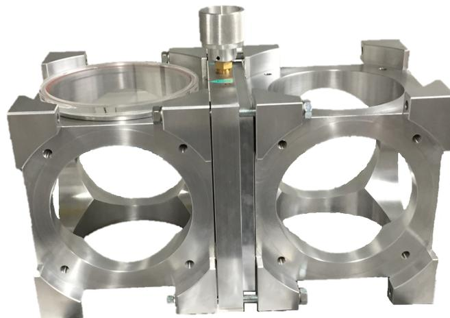
**Abbildung 3.7:** Quaderförmige Kammern aus Aluminium (25x20x25 cm, HxBxT), die durch ein Gate miteinander verbunden sind.
