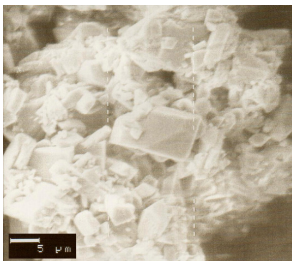
Abb. 6: REM-Aufnahme DCPA 1f (Eigenproduktion) ungemahlen
