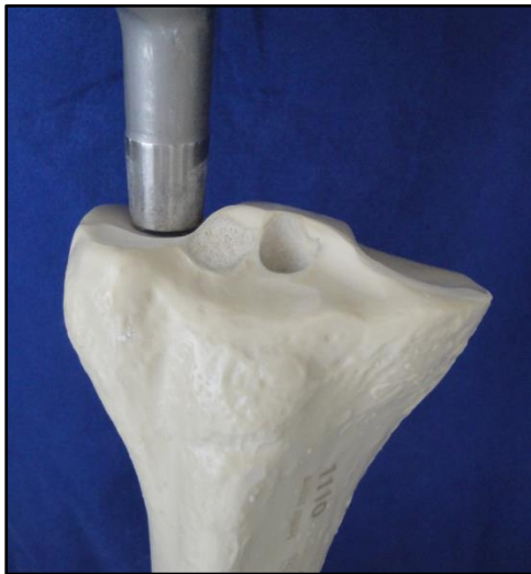
Abb. 21: Der Druckstempel wird auf die Sollbruchstelle im zentralen lateralen Tibiaplateau ausgerichtet.
