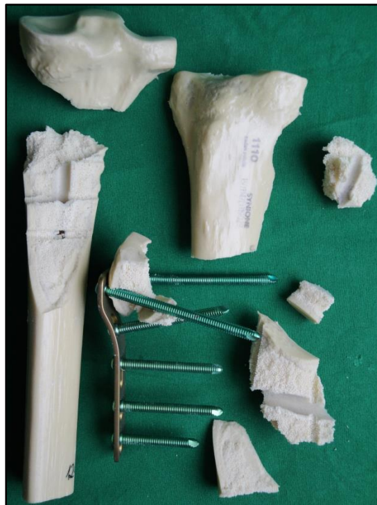
Abb. 58: Die Abbildung zeigt einen zersplitterten Kunstknochen aus der Gruppe Laterale Abstützplatte nach der Load-to-failure-Testung.
