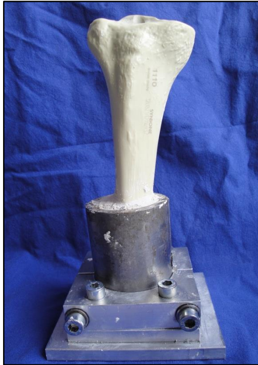
Abb. 18: Die Abbildung zeigt eine mit Gips in den Metallständer eingebettete rechte Tibia. Der Knochen ist in 5° Valgusstellung ausgerichtet.
