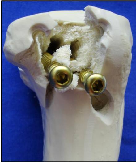
Abb. 56: Die Abbildung zeigt einen Knochen aus der Gruppe Zwei Schrauben . Auf Grund der Belastung durchschneiden die Schrauben den Knochen. Ein Teil des Tibiaplateaus ist abgeplatzt.
