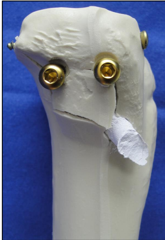
Abb. 54: Die Abbildung zeigt einen Knochen nach der biomechanischen Testung. Der Knochenzement Norian Drillable® ist durch das Kortikalisfenster herausgedrückt worden.
