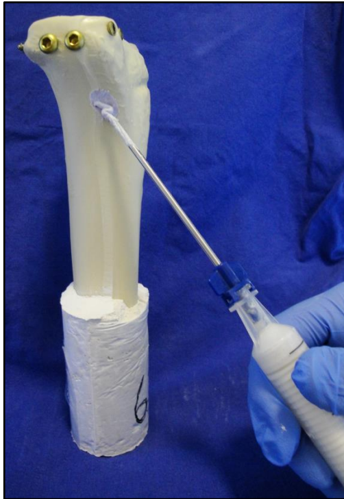
Abb. 36: Es wird die Applikation von Norian Drillable® zur Auffüllung der Defektzone dargestellt.
