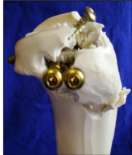
Abb. 57: Die Abbildung zeigt einen Knochen aus der Gruppe Jail-Technik . Die Kleinfragmentschrauben fangen einen Teil der axialen Belastung ab und verbiegen sich. Es ist kaum ein Durchschneiden der Schrauben zu erkennen.
