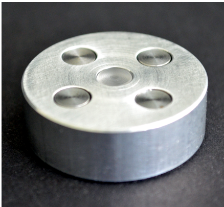
Abbildung 2.5: Links: Umsetzung des Multimaterialphantoms mit eingesetzten Stiften. Rechts: Tabelle der durch EDX Analyse ermittelten Zusammensetzung des Aluminiums. Die hohen Kupfer- und Blei-Anteile bewirken signifikante Absorptionsunterschiede im Vergleich zu reinem Aluminium.
