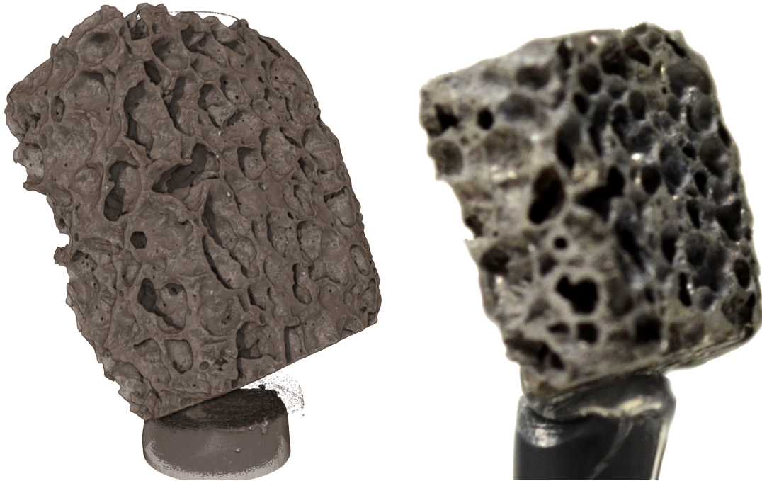
Abbildung 6.1: Modellbasierte 3D-Rekonstruktion (links) des Aluminiumoxid-Schaums neben einer Photographie der Probe (rechts).
