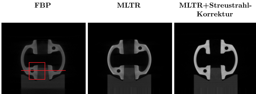
(a) Rekonstruktionsschichten des Kolbens in der xz -Ebene (senkrecht zur Drehachse). Es werden die gefilterte Rückprojektion mit Shepp-Logen-Fiter, die segmentierungsbasierte MLTR-Rekonstruktion und die segmentierungsbasierte MLTR-Rekonstruktion mit Simulation der Objektstreuung gezeigt. Grauwertspreizung: (0 - 1,0).
