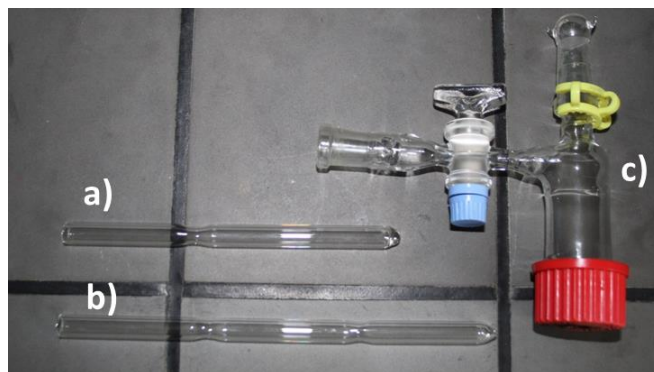
Abb. 6.4: Reaktionsampulle (a), Sublimationsampulle (b) sowie Quickfit mit Lösungsmittelaufsatz (c).
