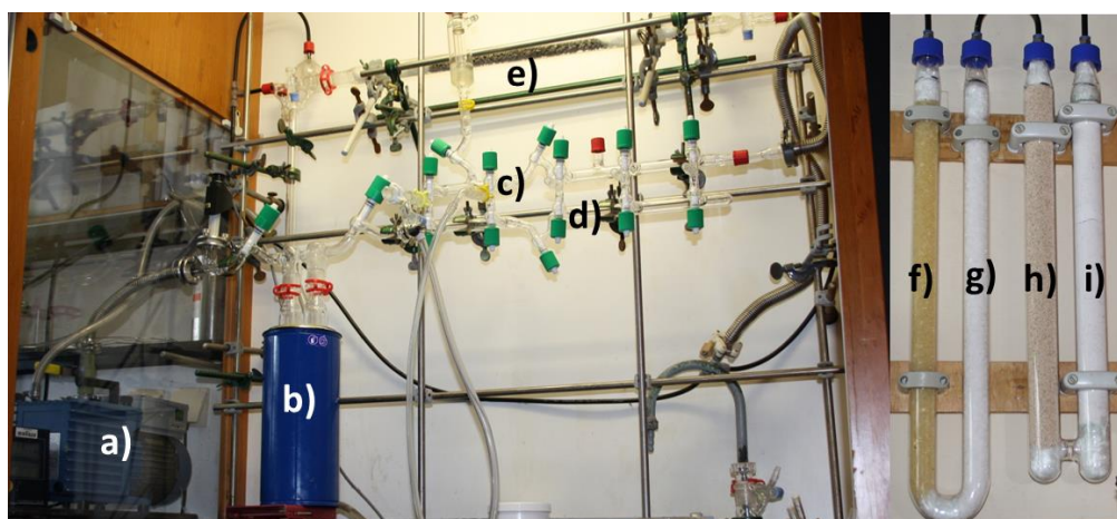
Abb. 6.3: Vakuum-Schutzgasanlage mit Drehschieberpumpe (a), Kühlfalle (b), Vakuumlinie (c), Schutzgaslinie (d), Glasrohr mit Titanschwamm (e) und Trockentürmen mit Silikagel (f), Kaliumhydroxid (g), Molekularsieb (h) und P_2O_5 (i).
