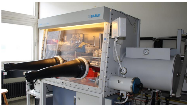
Abb. 6.2: Handschuhkasten LABMaster SP (Fa. MBraun) zur Analyse von Produkten.
