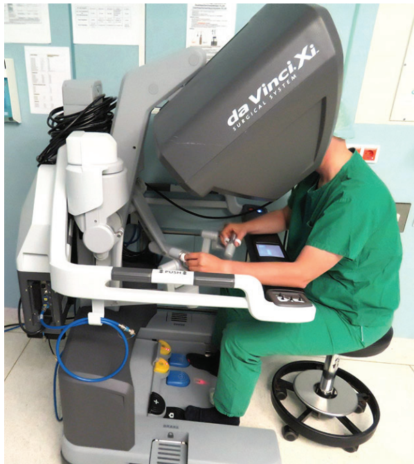
Der Operateur steuert die Roboterarme von einer Konsole aus. Seine Bewegungen werden dabei stark verfeinert und vollkommen zitterfrei. (Fotos: Andrey Svistunov / Uniklinikum Würzburg)
