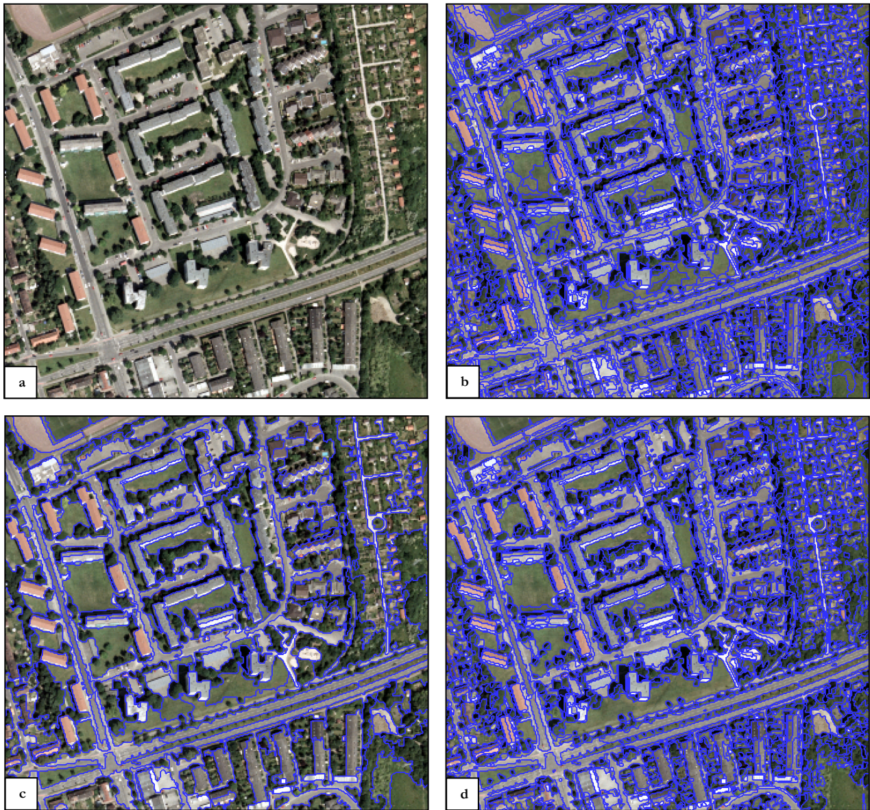
Abb. 4-17: Vergleich zwischen der Segmentierung eines hochauflösten Luftbildes (a) basierend auf der herkömmlichen Multiresolution Segmentation (b, c) und der klassenbasierten Segmentoptimierung (d) – Während auf der Basis der Multiresolution Segmentation jeweils eine separate Ebene zur Repräsentation kleiner (b) bzw. großer (c) Objekte angelegt werden muss, werden die Objekte im Kontext der Prozedur zur Segmentoptimierung direkt in ihrer optimalen Ausdehnung auf einem einzigen Level erfasst (d).
