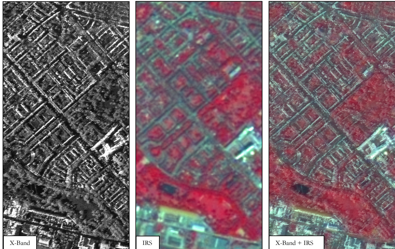
Abb. 4-43: Erscheinungsbild einer Siedlungsfläche in höchstauflösenden SAR-Daten (X-Band, 2m), geringer aufgelöster optischer Aufnahme (IRS, 5.8m) sowie Überlagerung beider Datensätze – Im Hinblick auf die SAR-Aufnahme limitiert vor allem der eingeschränkte spektrale Informationsgehalt die Analyse der urbanen Strukturen, während es der IRS-Aufnahme an der notwendigen geometrischen Auflösung mangelt. Die Fusion beider Datensätze illustriert den potentiellen Nutzen einer synergetischen Auswertung der komplementären Bildinformation beider Datentypen.
