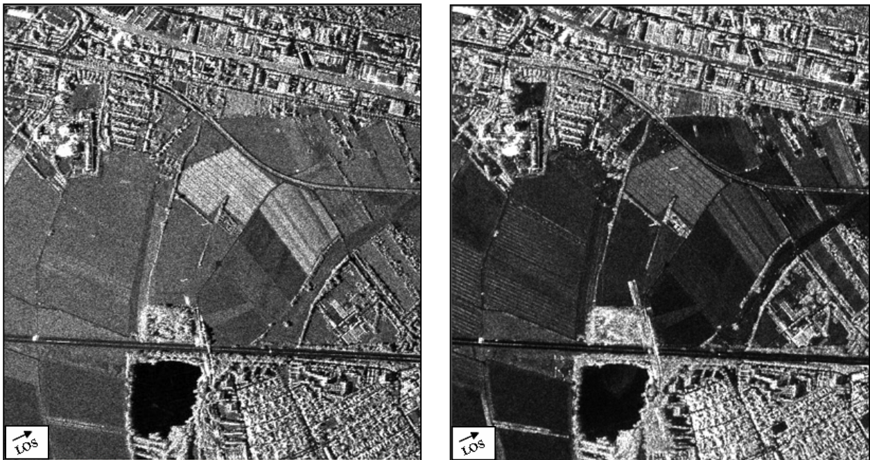
Abb. 2-5: Wellenlängenabhängige Variation der Radarrückstreuung zwischen X-Band (l.) und L-Band (r.) – Ackerbaulich genutzte Freiflächen wirken im langwelligeren L-Band überwiegend als glatte Oberflächen mit entsprechend geringer Rückstreuung (dunkel). Gleichsam nimmt die Eindringtiefe mit abnehmender Frequenz zu – gut zu erkennen am Muster der Bodenstrukturen im Kontext vegetationsbedeckter Ackerflächen (zentral links), die zwar im L-Band, jedoch nicht im X-Band in Erscheinung treten.
