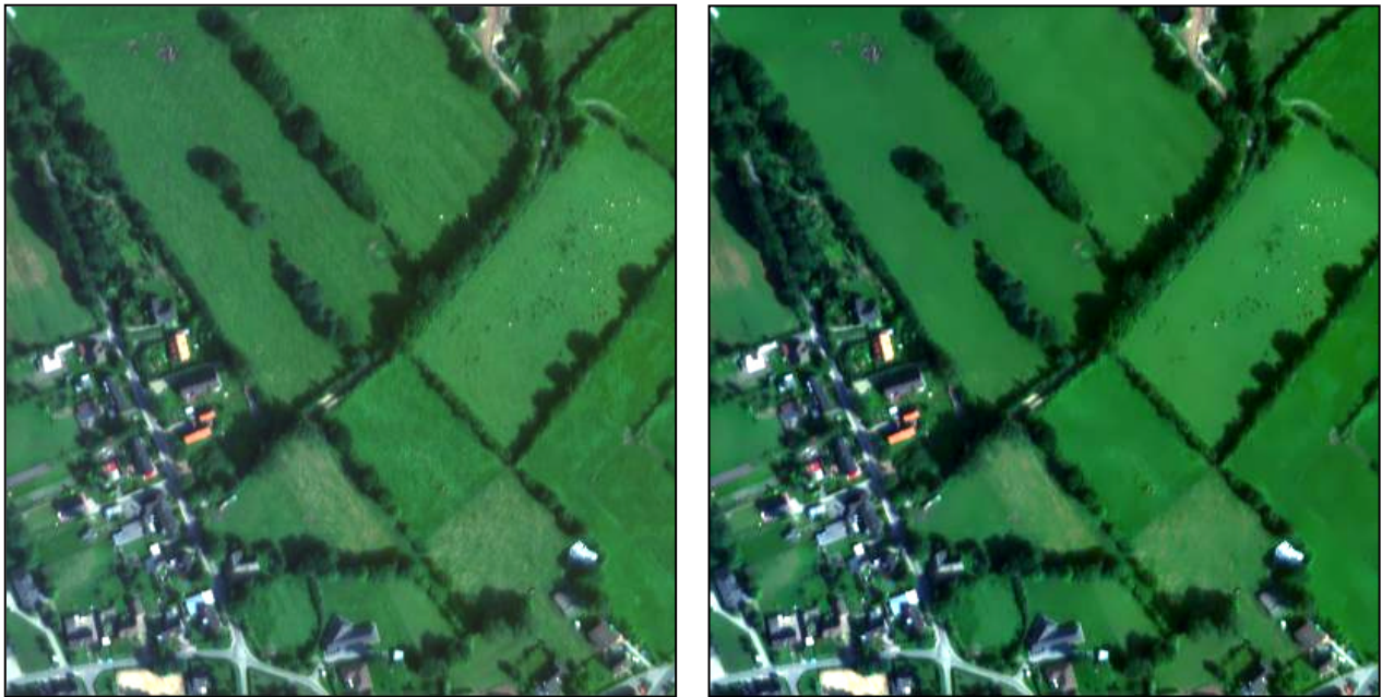
Abb. 4-11: Einsatz des SelectiveMean-Filters zur Aufwertung optischer Daten (HRSC) – Die Filterung wurde auf jeden Aufnahmekanal (RGB) separat angewendet und die geglätteten Bänder anschließend zu einem Komposit zusammengefügt. Durch die Glättung homogener Flächen bei gleichzeitiger Bewahrung der Kanteninformation heben sich die einzelnen Struktureinheiten nach der Filterung bedeutend klarer voneinander ab.
