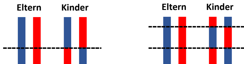
Abbildung 20. Schematische Darstellung der Rekombination eines binären (links) und eines ganzzahligen Strings (rechts).
