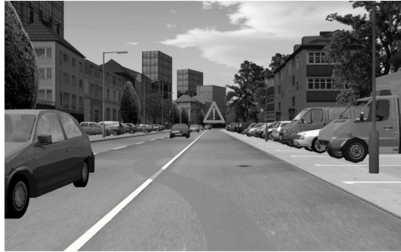
Abbildung 8-4. Szenario für die Untersuchung des unberechtigten Systemeingriffs. Die Abbildung zeigt den fehlerhaften Eingriff mit visueller Warnung zur Verdeutlichung der Trajektorie des Fahrzeugs.
