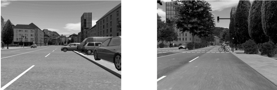
Abbildung 6-2: Umsetzung der Szenarien im Fahrsimulator. Dargestellt ist das Szenario Ausparken (links) und querender Radfahrer (rechts). Sowohl der PKW als auch der querende Radfahrer waren vor Beginn der Situation durch Sichthindernisse (z. B. parkende Fahrzeuge oder Büsche) verdeckt.
