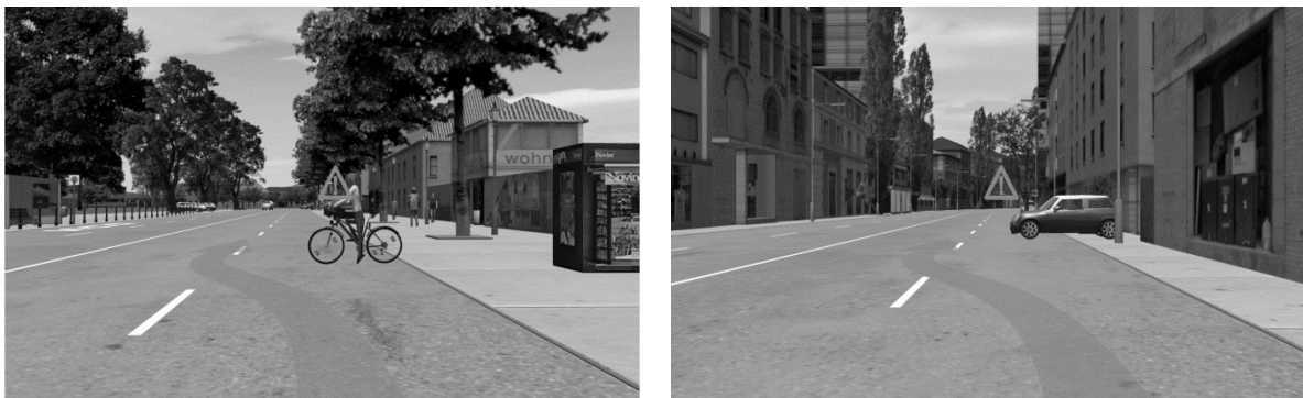
Abbildung 8-3. Szenarien für den Nutzenfall mit kreuzendem Radfahrer (links) und PKW (rechts). Die Abbildungen zeigen je einen Eingriff mit visueller Warnung zur Verdeutlichung der vom System gefahrenen Trajektorie. Beide Hindernisse waren zu Beginn der Situation durch Sichthindernisse verdeckt.
