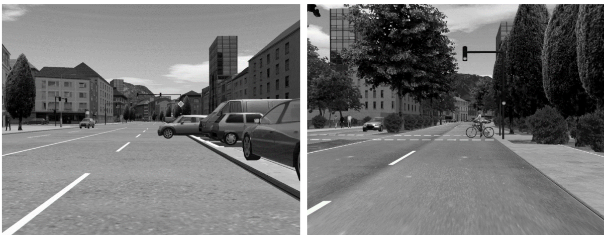
Abbildung 7-1: Umsetzung der Szenarien im Fahrsimulator. Ausparker/Querverkehr (links) und querender Radfahrer (rechts). Sowohl der PKW als auch der querende Radfahrer waren vor Beginn der Situation durch Sichthindernisse (z. B. parkende Fahrzeuge oder Büsche) verdeckt.
