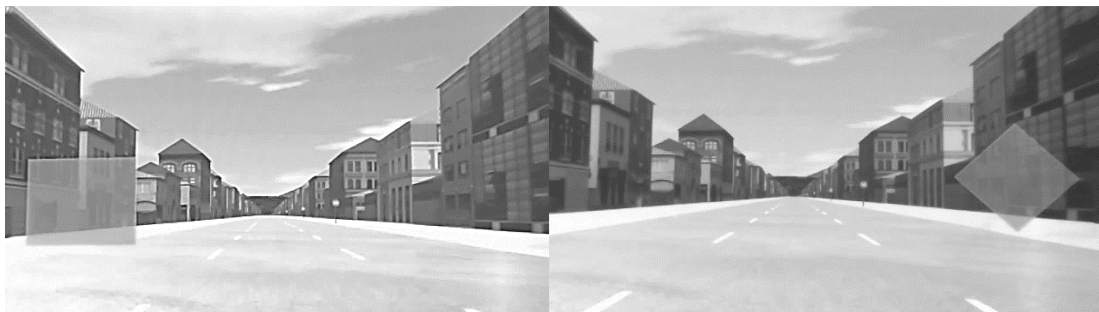
Abbildung 5-2. Beispielhafte Darstellung des Aufbaus der Teststrecke und der beiden Stimuli. Die Stimuli erschienen bei einer TTC von 1.6 s und bewegten sich in Richtung der mittleren Fahrspur.
