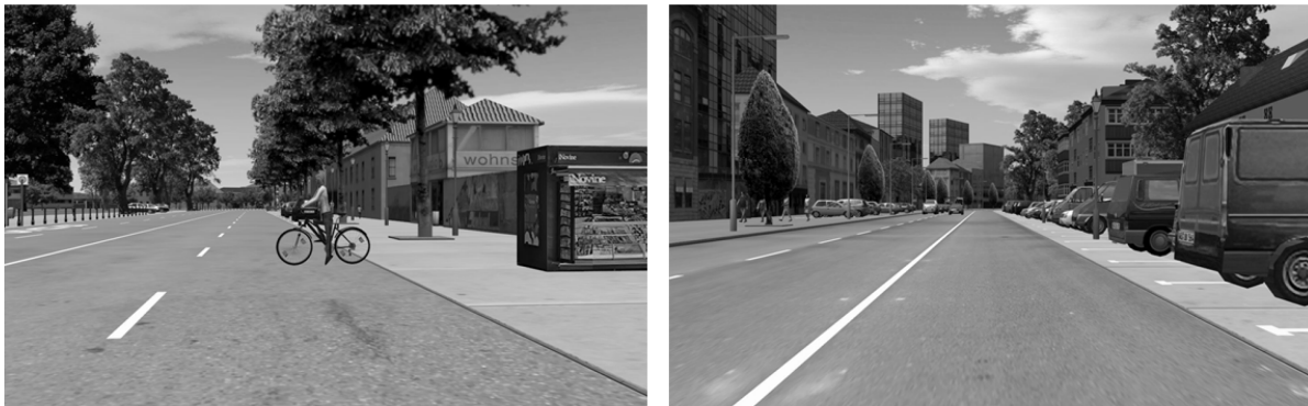
Abbildung 10-1. Szenario für den Nutzenfall (links) und ein beispielhaftes Szenario für den Fehlerfall (rechts). Im Nutzenfall konnten die Fahrer ungehindert auf den Nachbarstreifen ausweichen, ohne andere Verkehrsteilnehmer zu gefährden. Im Fehlerfall mussten die Fahrer aktiv ein Verlassen der eigenen Fahrspur verhindern um sich selbst und den Gegenverkehr nicht zu gefährden.
