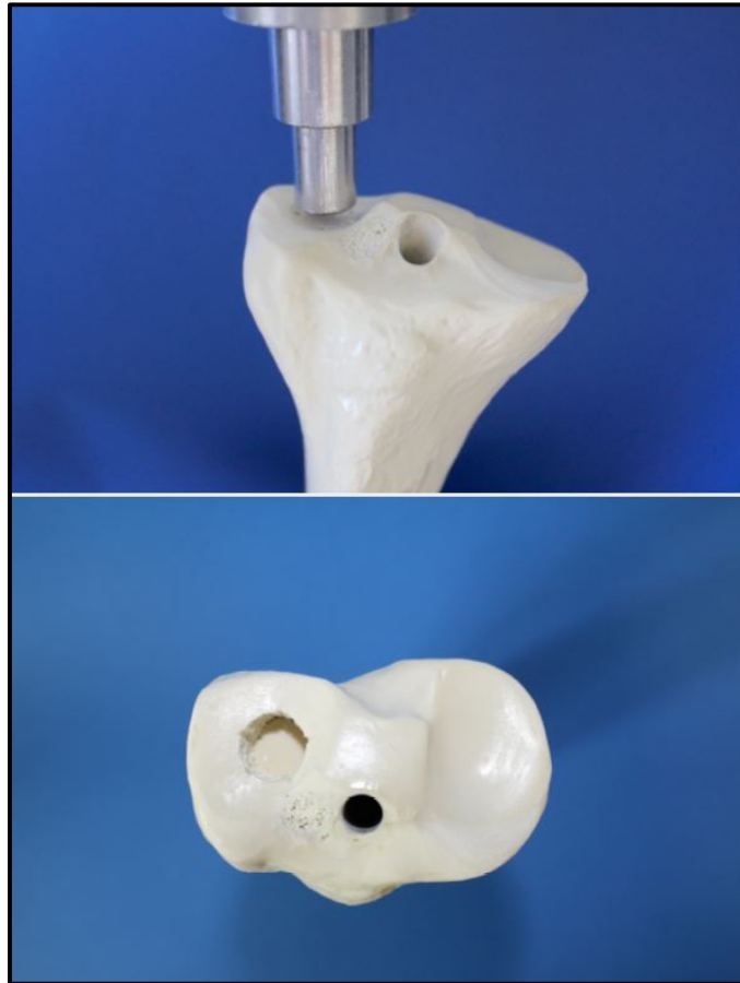
Abbildung 19: Ablauf der Frakturgenerierung; Platzierung des Stempels auf dem lateralen Tibiaplateau (oben) und daraus resultierende Impressionsfraktur (unten)
