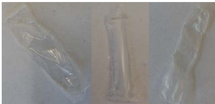
Abb. A1-2: Transparente Polymermatrizen, PVC (links), PS (mittig) und TPX (rechts).
