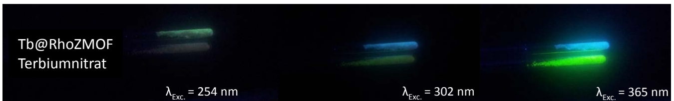
Abb. 4.114: Fotografien der Lumineszenzeigenschaften von Tb@Rho-ZMOF und Terbiumnitrat bei einer Anregung mit 254 nm, 302 nm und 365 nm (von links nach rechts).
